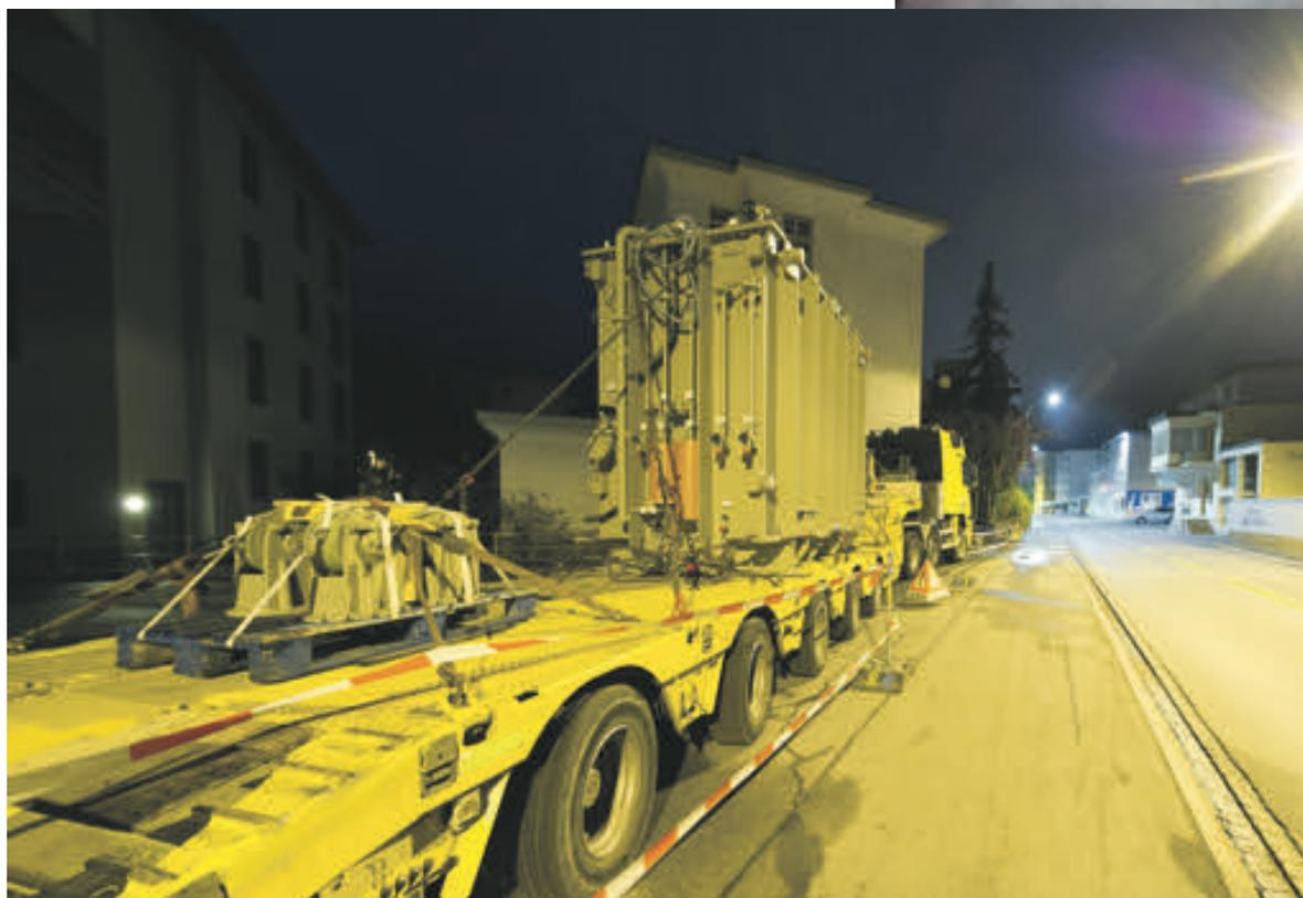
Die neue, stärkere Trafo-Station für das Unterwerk an der Talstrasse wird in einer Nachtübung mit einem Schwertransport angeliefert.
