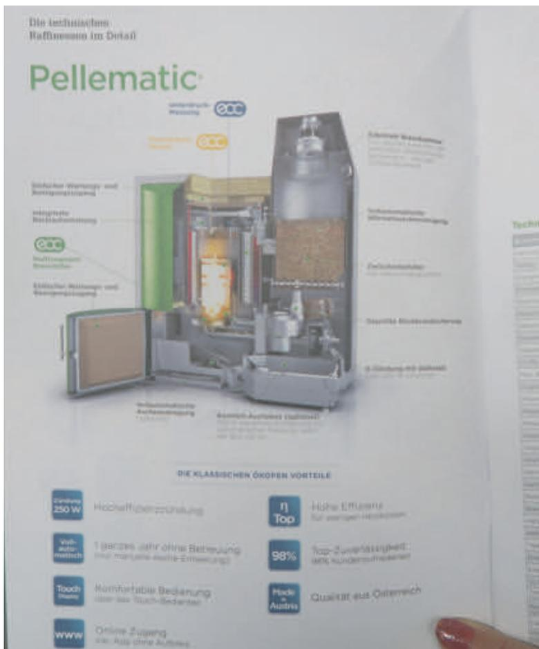
Der Pellematic des österreichischen Herstellers hat diverse technische Raffinessen, z.B. eine vollautomatische Ascheabfuhr, eine Edelstahl Brennkammer, vollautomatische Wärmetauscherreinigung, E-Zündung mit Glühstab. Vorteile u.a. ein Online-Zugang, komfortable Bedienung mit Touch Display, ein ganzes Jahr in Betrieb ohne spezielle Betreuung.
