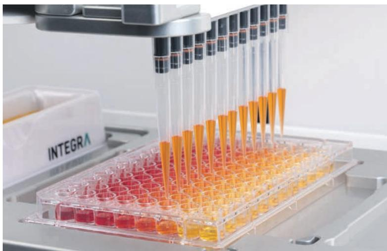
*Einer der Pipetting-Roboter von «Integra» in Aktion.*
