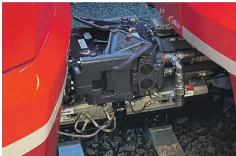
Bild links: Den Lokführern steht die modernste Führerkabine zur Verfügung, High Tech pur. – Rechts: Eine absolute Neuheit des Regionalzugs ist die automatische Kupplung. Nun kann in Klosters z.B. eine Einheit nach Scuol und die andere nach Davos weiterfahren. Total können 16 Triebwagen gekoppelt werden.
