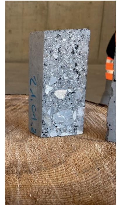
Wie aus den Bestandteilen des Betons Klimabeton wird, zuoberst die Schicht Pflanzenkohle. Bild rechts zeigt ein Mauerstück in dem die Pflanzenkohle sogar klar sichtbar ist.
