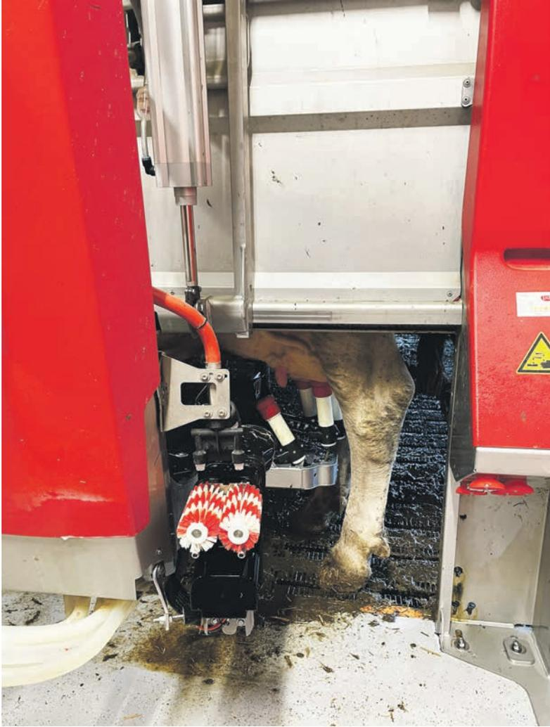
Der Melk-Roboter erleichtert die Arbeit des Landwirts massiv und unterstützt seine Arbeit mit wichtigen statistischen Informationen. Der Roboter weiss, welche Kuh in den Stand kommt, reinigt mit den Bürsten die Zitzen, entnimmt die Milch und liefert die Daten aufs Handy des Betriebsleiters.
