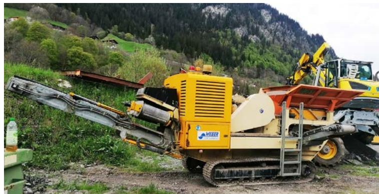
Mobile Brechanlage, Transport mit Hakengerät
