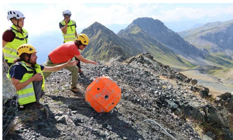
Steinschlagversuche auf dem Weissfluhjoch, Sommer 2024. Ein künstlicher Stein wird angerollt. (Foto J. Bettzieche, slf)
